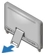
Figura 3. Instalarea suportului din spate
